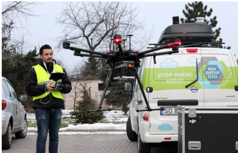
Eko-patrol GIG dysponuje samochodem z napędem elektrycznym, wyposażonym w czujniki umożliwiające ciągły pomiar czystości powietrza w trakcie jazdy. Odpowiedni program nanosi wyniki bezpośrednio na mapę. Z kolei dron wykonuje pomiary nad kominami posesji.
